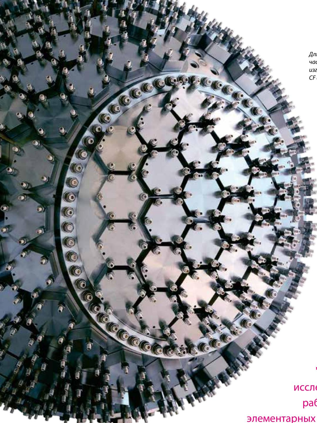
Для определения формы элементарных частиц используется сферическая камера изготовленная PINK диаметром 650 мм с 230 CF фланцами DN 40.
