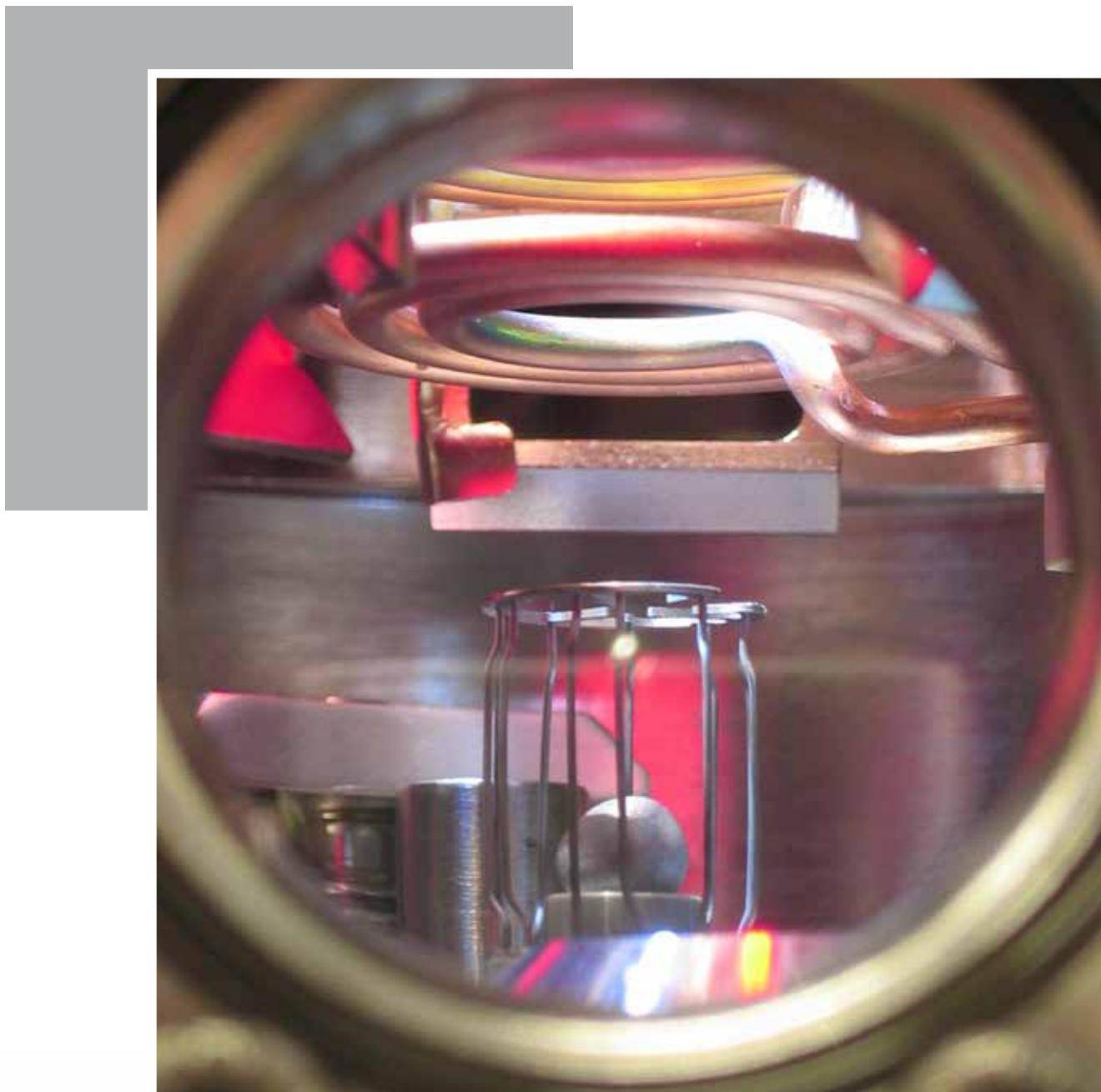
*Расплавленные опытные образцы приобретают в электромагнитном поле в невесомости идеальную сферическую форму. Это чрезвычайно увеличивает точность измерений.*
