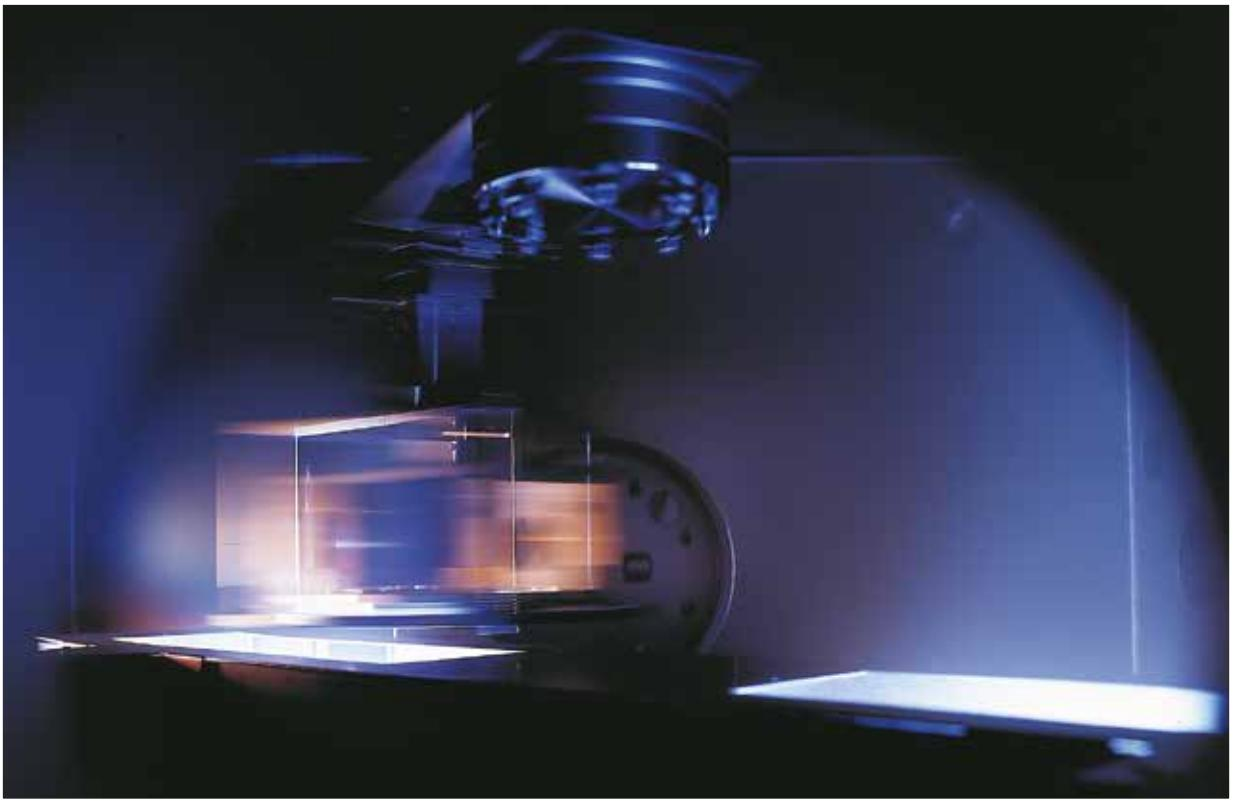
Вид внутри вакуумной камеры в процессе магнетронного распылителя.
