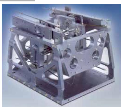
В этой системе для избирательного отклонения синхротронного излучения PINK отвечает за регулировку зеркал с твердотельными элементами (то есть без движущихся частей).
