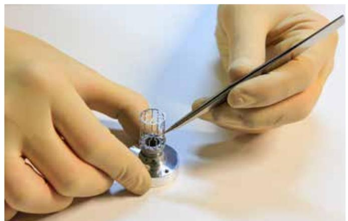
Сетчатые ячейки, сделанные с применением электронно-лучевой сварки специальных металлов, изготовлены на заводе PINK для удерживания образцов. В этих сетчатых ячейках образцы материала фиксируются во время экспериментов в невесомости, а затем в них же, после термообработки, возвращаются на Землю.
