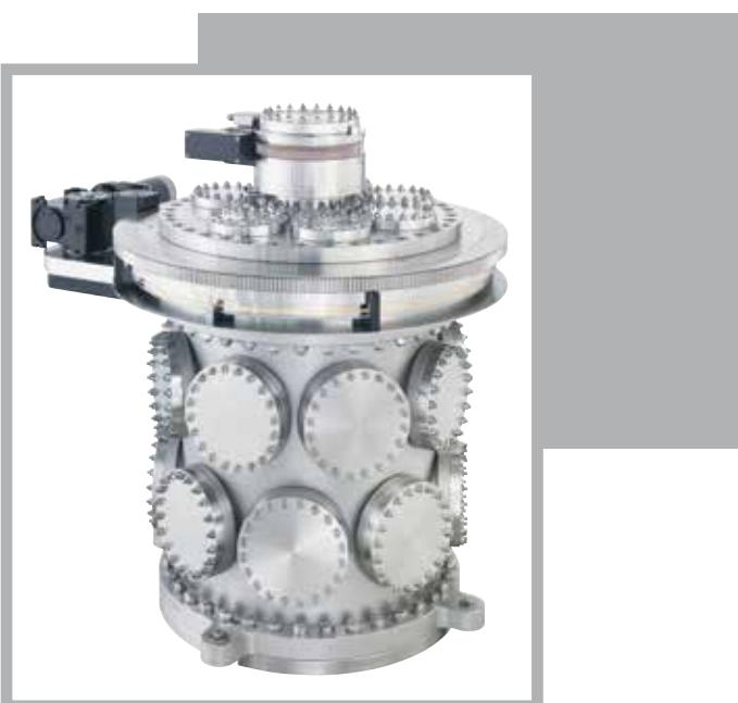
Система измерения вакуума для фундаментальных исследований (скорость натекания  $\leq 10^{-9}$  мбар\*л / с), кроме всего прочего, имеет 2-кратное дифференциальное вакуумирование врачающихся соединений DN 160 CF и DN 500 COF и систему измерения положения (угловая точность 0,001°), приводимая в действие шаговым двигателем (скорость вращения ~ 0,5 об/мин).
