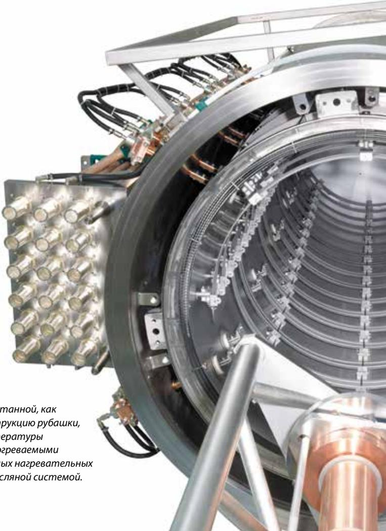
Вид внутри высокотемпературной вакуумно-паяльной системы, разработанной, как вакуумная печь с холодной ретортой (внешние стенки печи имеют конструкцию рубашки, по которой циркулирует охлаждающая жидкость). Для достижения температуры технологического процесса до 1200 °C камера печи оснащена девятью обогреваемыми сопротивлениями зон в виде индивидуально контролируемых радиационных нагревательных элементов из молибдена. Высокий вакуум генерируется полностью безмасляной системой.
