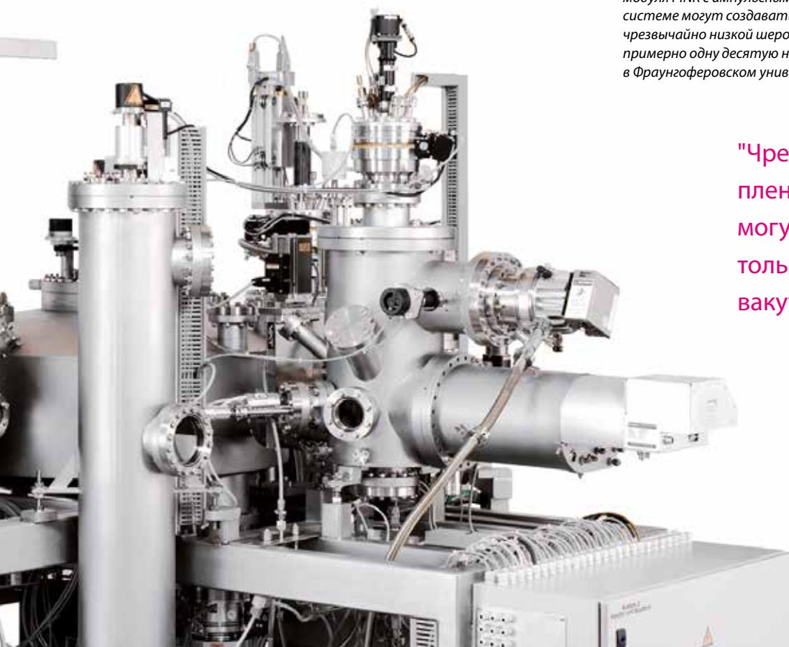
"Чрезвычайно тонкие пленки высокой чистоты могут быть получены только при сверхвысоком вакууме."
