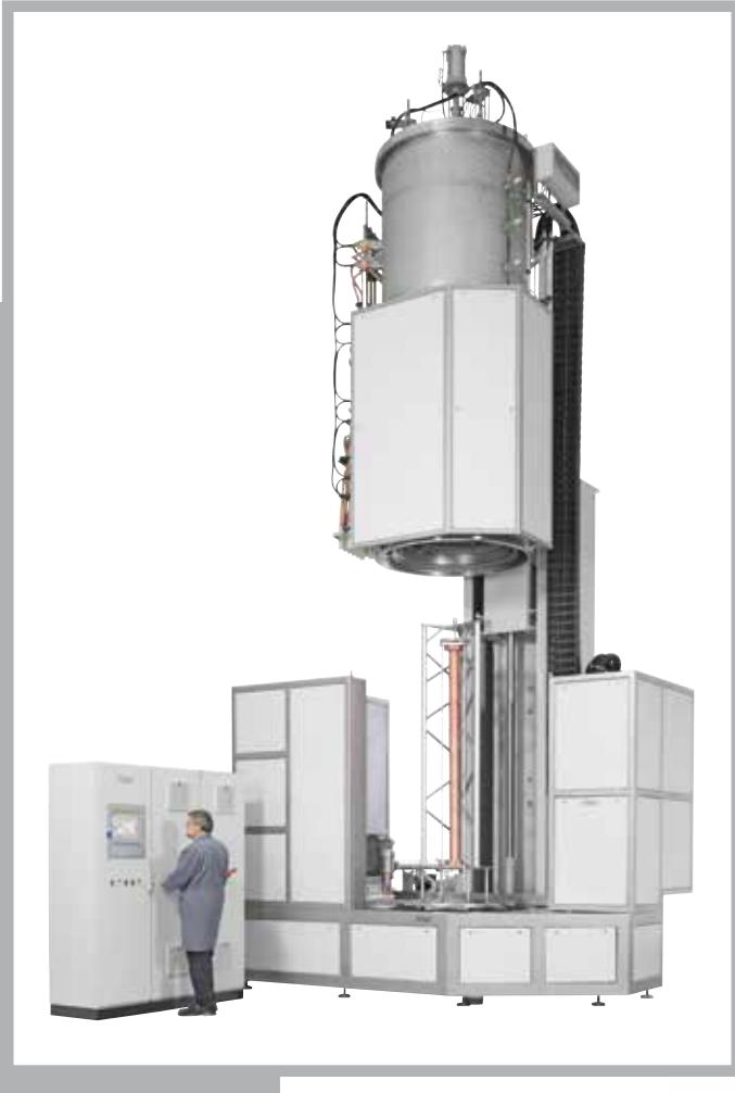
Вакуумная паяльная печь для FEL (Швейцария) высотой 6 м выполнена, в основном, из нержавеющей стали. Цилиндрическая камера печи может быть поднята и, с открытым колпаком, составляет высоту почти 9 метров. Эта специальная конструкция позволяет производить вакуумную пайку вертикально вставленной заготовки диаметром до 800 мм и высотой до 2700 мм, с весом садки до 1000 кг.
