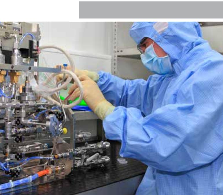
Работа по сборке сверхвысоковакуумной камеры в исследовательском модуле EML (электромагнитном левитаторе) в чистом помещении PINK
