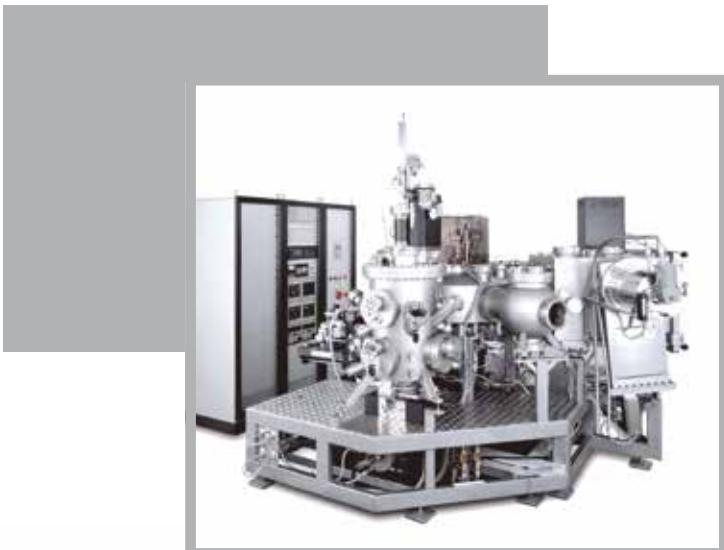
Кластерная система напыления для производства рентгеновских зеркал
