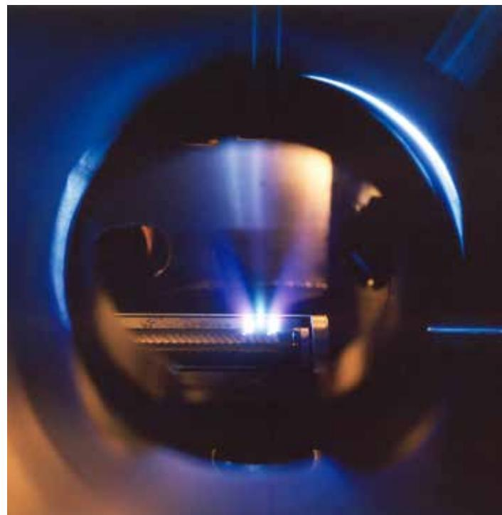
Производство рентгеновских зеркал со сверхнизким рассеиванием: технологическая UHV камера кластерного модуля PINK с импульсным лазерным напылением. В данной системе могут создаваться многослойные пленки с чрезвычайно низкой шероховатостью, составляющую примерно одну десятую нанометра. (На фото: установка в Фраунгоферовском университете)
